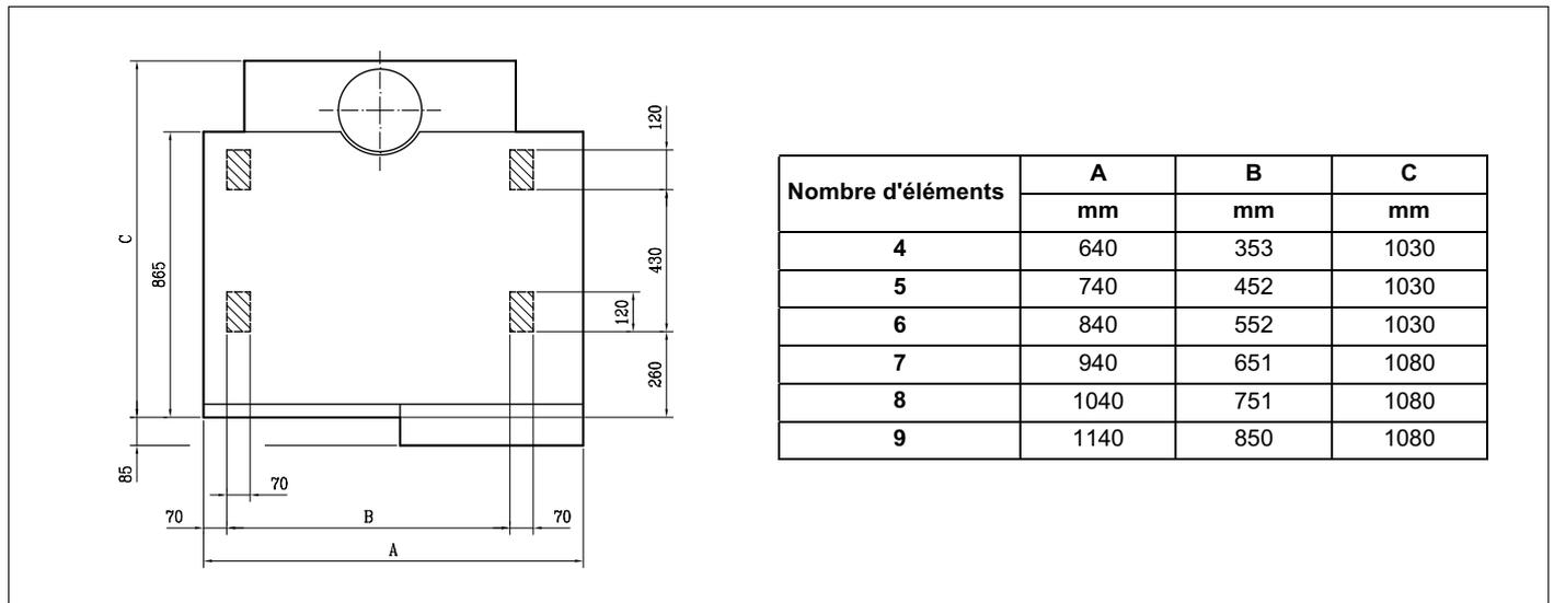
Fig. 05 Schéma d'implantation
